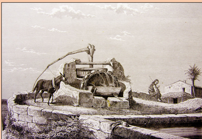
Noria de tiro. Grabado de la obra del Archiducque Luis Salvador de Austria. Las Baleares por la palabra y el grabado (1869)
