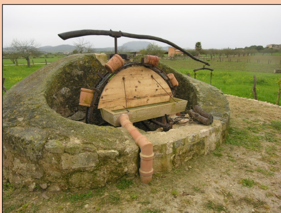
Noria de tiro de hierro y arcaduces de sa Torre (Montuiri) Noria de tiro de tambor de sa Vela Gran (Andratx)
